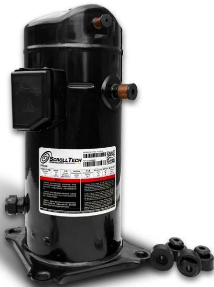
Низкотемпературные спиральные холодильные компрессоры ScrollTech серии ST-F холодопроизводительностью от 1,94 до 14,1 кВт. Они используются в составе коммерческих и промышленных холодильных машин, предназначенных для низкотемпературных холодильных камер продовольственных магазинов и небольших холодильных складов, шоковой заморозки. Выпускаются модели со впрыском пара, что позволяет увеличить холодопроизводительность системы до 40 %.
